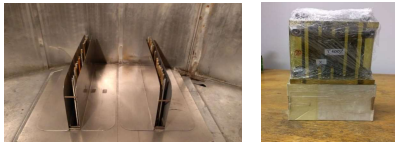
Komora napromienienia z przętami paliwowymi w JINR Sosny i forma z próbkami 8 h po ekspozycji
