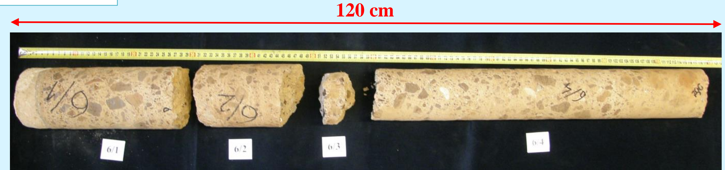
Odwierty o średnicy 100 mm pobrane ze ściany osłony reaktora
